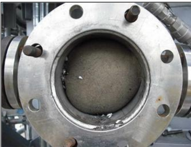
Rysunek 3. Odbiór kreta w stacji odbioru.
