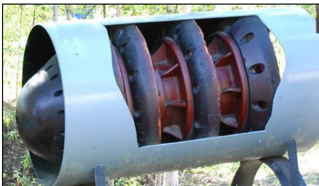
Rysunek 1. Widok kreta w rurociągu Trans-Alaska (źródło: www.wikipedia.org ).
