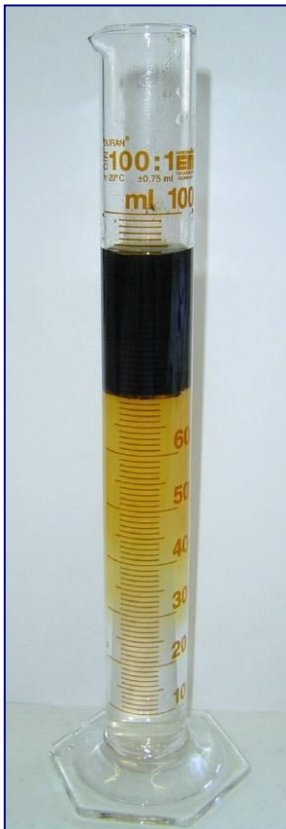
Foto 2: Scheiding van Veclean LowCOD in een olie en waterfase.
