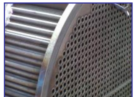
Warmtewisselaar voor en na reiniging
