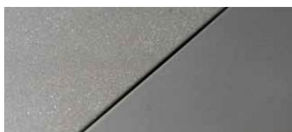
Rechts: behandeld met het waterstraal proces Links: behandeld met conventioneel parelstralen
