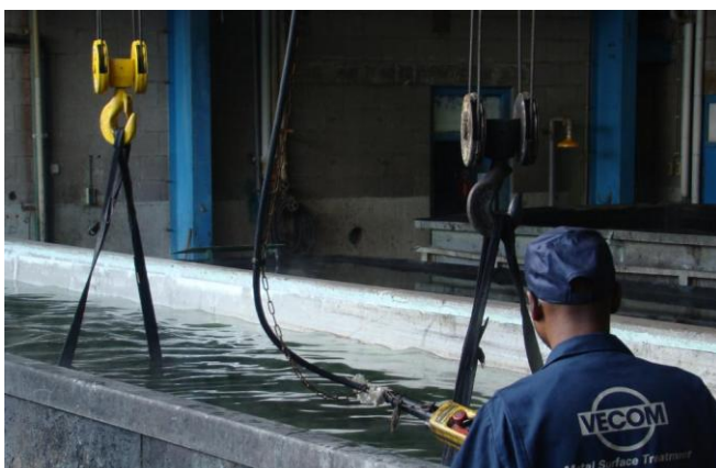
Koolstofstaal wordt in het zinkfosfateerbad gedompeld
