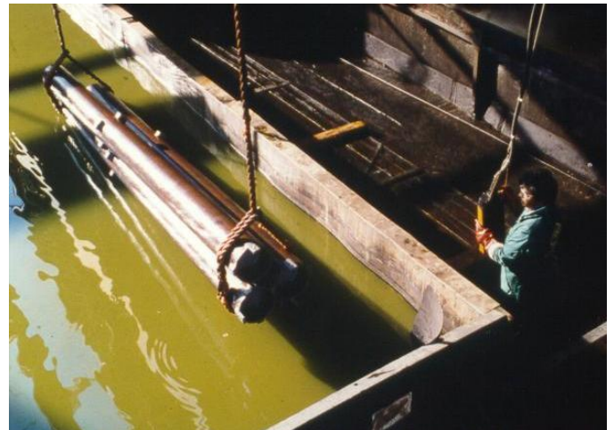
Dompelen van koolstofstalen leidingen in een fosfateerbad; roest wordt verwijderd en een fosfaatlaag blijft achter
