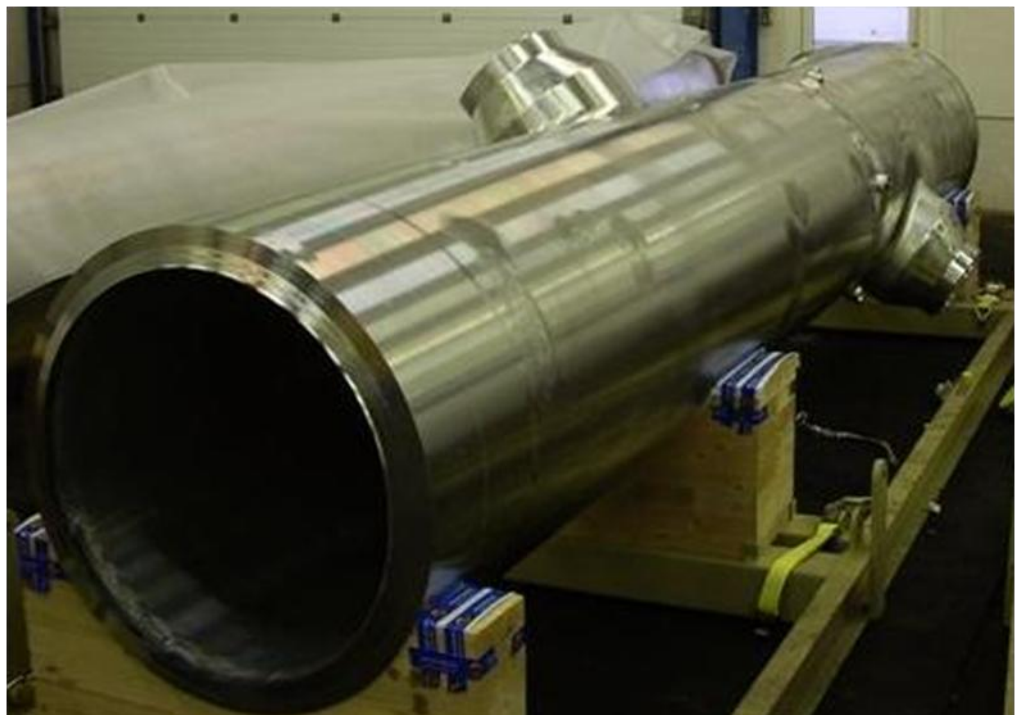
Afb 3: RVS 316 leidingdeel na de beitsbehandeling. Op deze foto is de wanddikte van 91 mm goed te zien.
