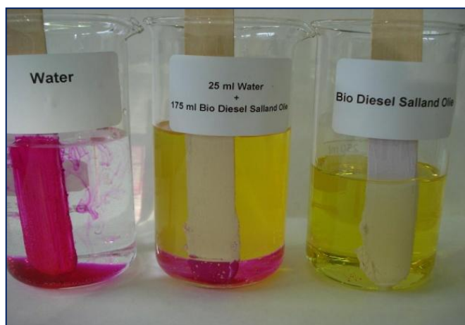
Aantonen van water onder Biodiesel
