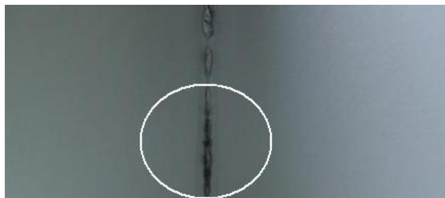
Foto 2: koolstofinbranding in een lasnaad (hier 316L)
