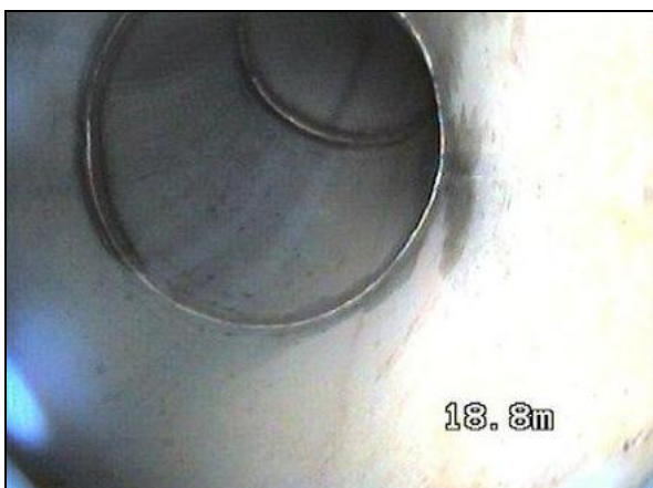
Leiding 2 – Bewijs dat de leiding op enig moment voor de helft is ondergedompeld in beitszuur, waarbij de onderste halve cirkel van de lasnaad is gebeitst en waarbij de bovenste halve cirkel onbehandeld is gebleven
