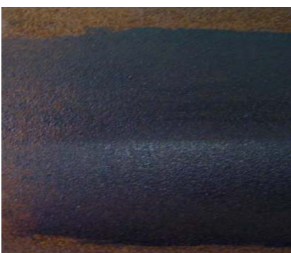
Boven: direct na het opbrengen; Onder: na inwerking is een blauw-zwarte inerte laag ontstaan
