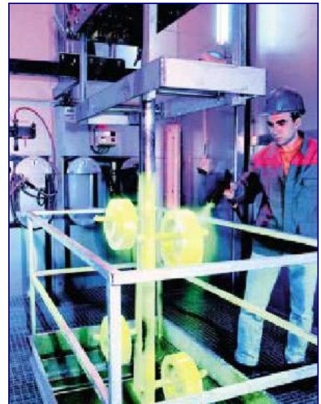
Fluorescerende penetranten geven sneller een indicatie dan rode
