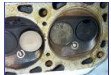
Gereinigde klep Niet-gereinigde klep
