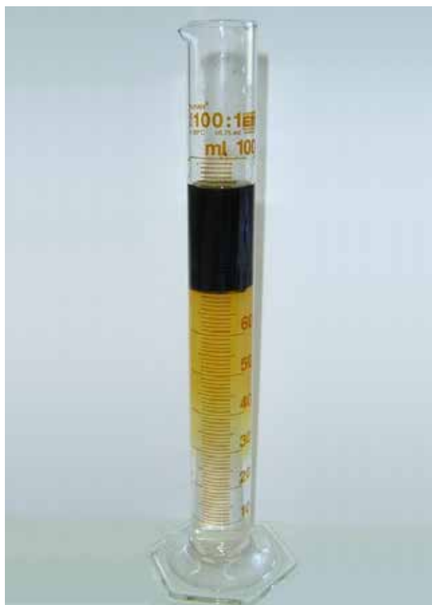
Scheiding van Veclean LowCOD in een olie en waterfase
