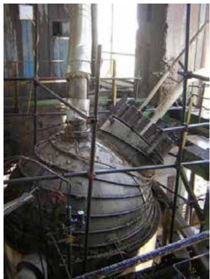
Bovenzijde van een ureum stripper in Iran
