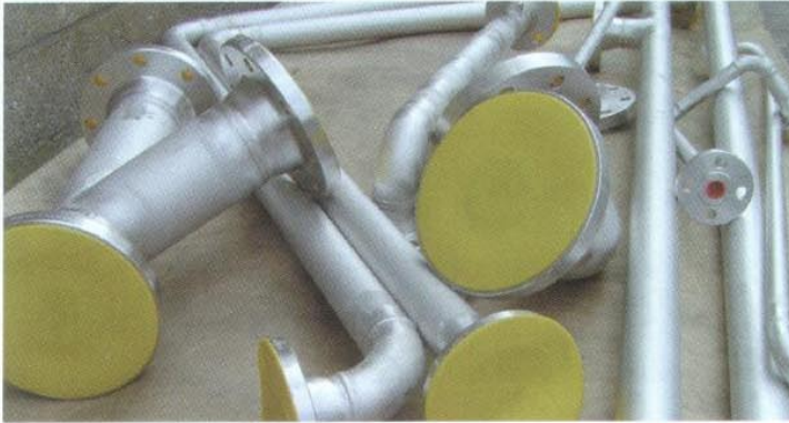
Afbeelding 2 Gereinigd leidingwerk middels dompelbeitsen.
