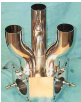
Werkstuk na elektrolytisch polijsten
