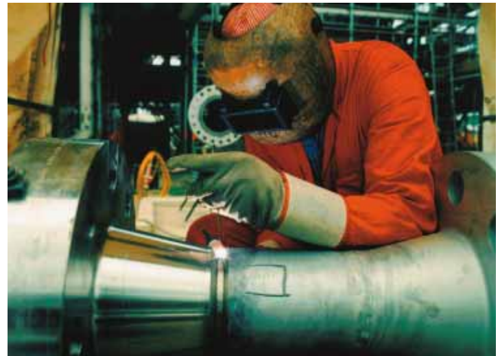
Het is van essentieel belang dat de lasverkleuringen verwijderd worden vooraleer het rvs wordt blootgesteld aan een agressief of waterig milieu
