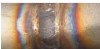
Tijdens lassen van rvs ontstaat de typische lasverkleuring door oxidatie van het metaaloppervlak
