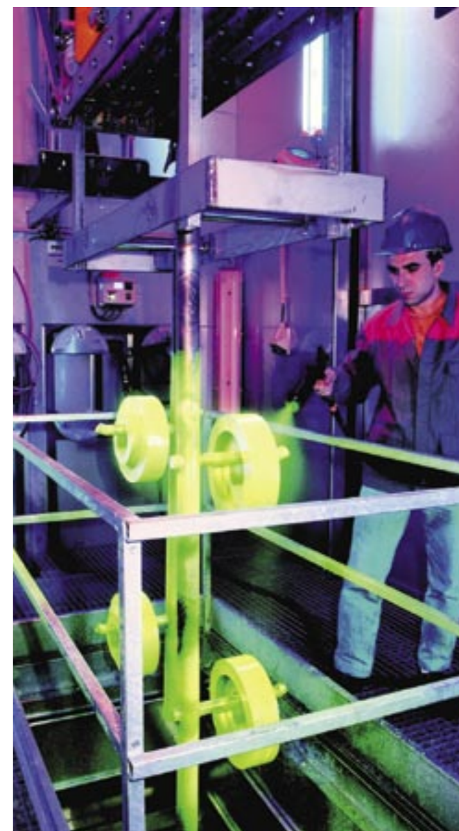
Fluorescerende penetranten geven sneller een indicatie dan rode.
