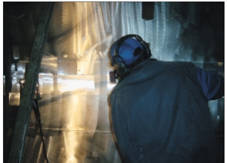
Slijpen, polijsten en borstelen hebben als doel een bepaalde finish van het roestvaststalen oppervlak te verkrijgen
